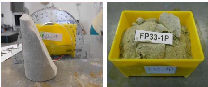
Kovári mérések két jellemző tönkremeneteli képe
