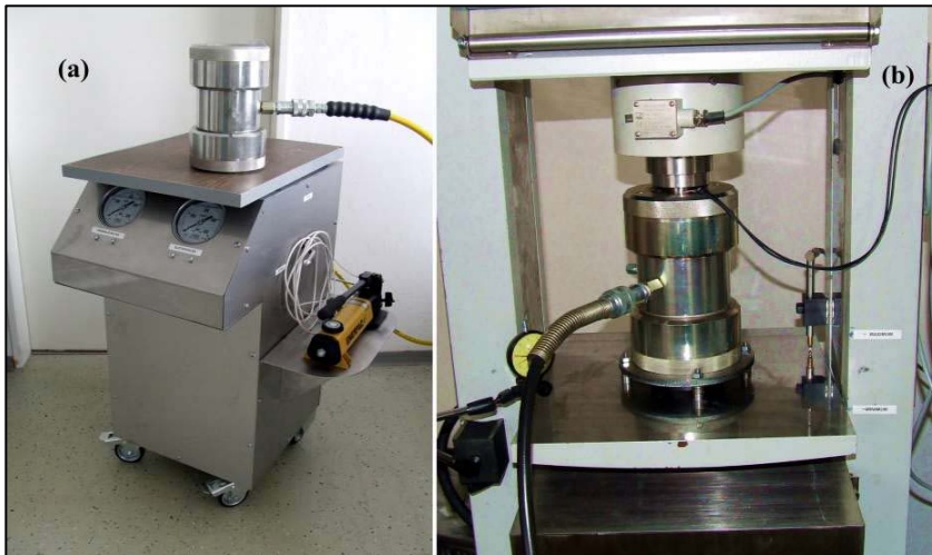
Tönkremeneteli határgörbe meghatározását – Kovári teszt – végző triaxiális mérőberendezés
