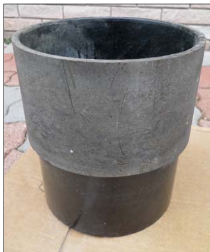
3. ábra Hőszigetelő elem bakelitből
